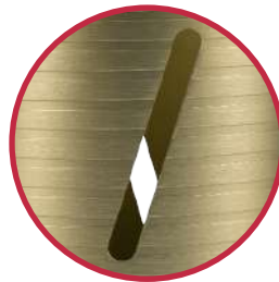
Ranura de Ventilación, evacuación de polvo y ayuda para sacar el testigo.
