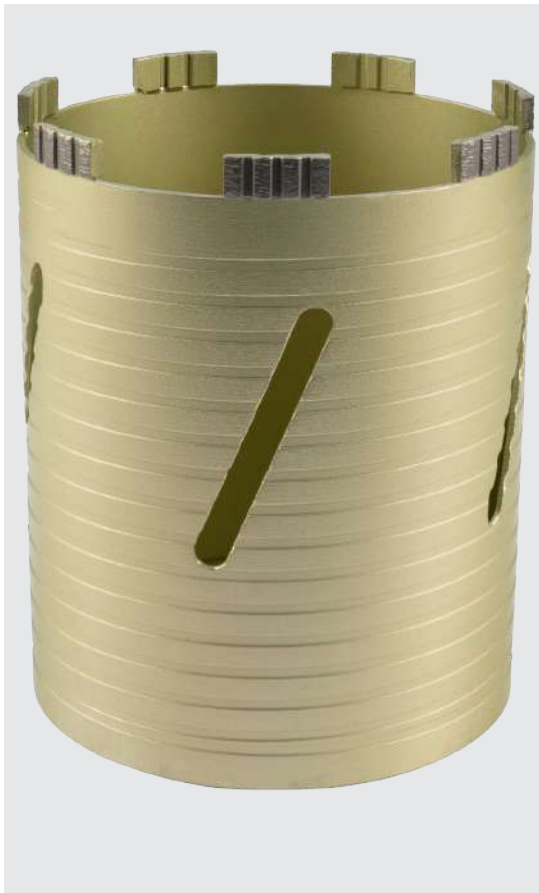
Ranura de Ventilación, evacuación de polvo y ayuda para sacar el testigo.
